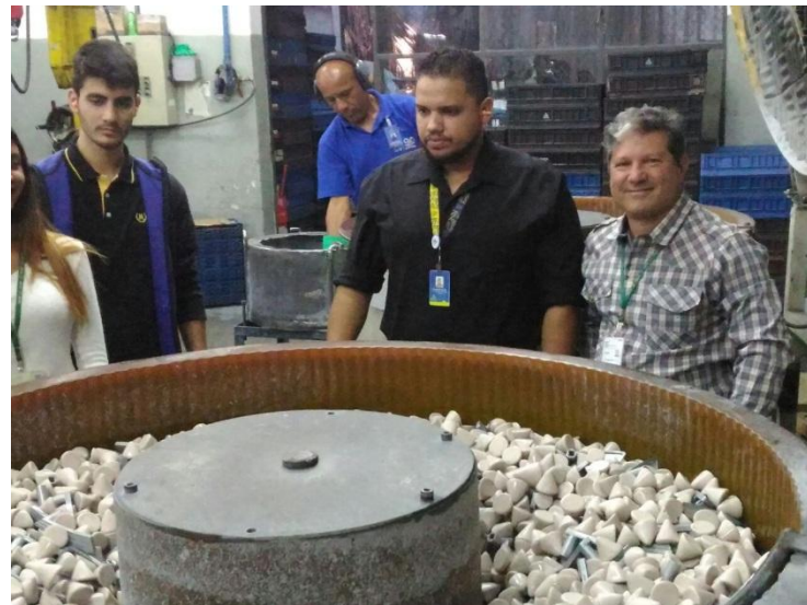
Processo produtivo do acabamento com máquinas vibratórias, retirada de rebarbas
