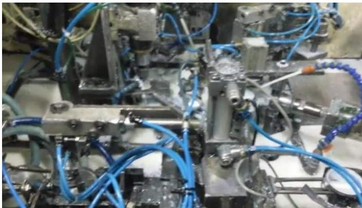
Célula de produção automática executando algumas operações do registro de gás
