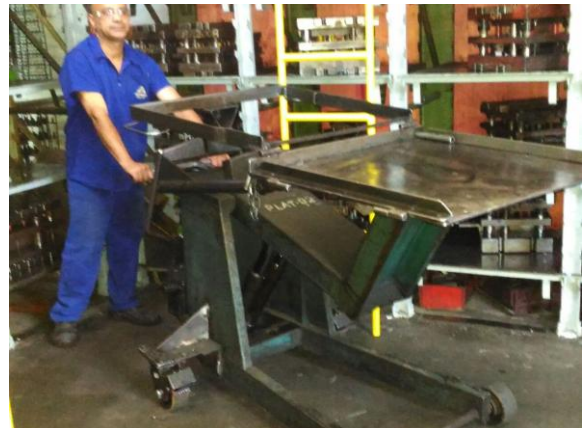
Possibilidade de projeto: Dimensionamento do agregado hidráulico do carrinho de plataforma hidráulica, para que o mesmo tenha movimento de subida e descida e de deslocamento automáticos.
