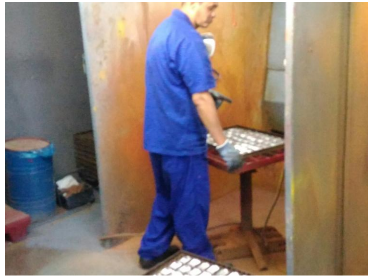
Processo produtivo do acabamento com pintura líquida manual
